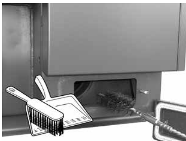
Ukázka čištění a vybírání prachu ze zadního kouřového kanálu - pod spodním víčkem
