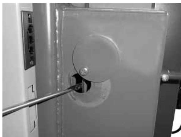
Kontrola a čištění regulace poměru primárního vzduchu čistícím otvorem
