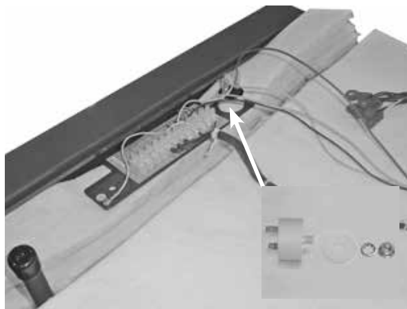
Kondenzátor odtahového ventilátoru UCJ4C52 - 1μF / UCJ4C82 - 2μF (KORA - 3μF)
