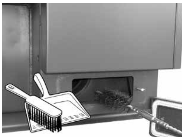
Ukázka čištění kouřového kanálu - spodní víčko
